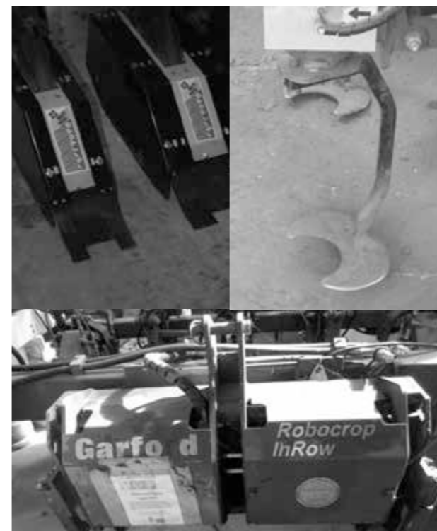
Slike 28, 29 in 30: Okopalnik s frezo za medvrstno obdelavo – ščetki varujejo okopavino (levo) in delovno telo (sredina) za okopavanje v vrsti na robotiziranem okopalniku (desno)
